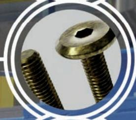
Sustituto del acabado cuero. Se aplica inicialmente un latonado seguido de una oxidación química que lo oscurece. Posteriormente se revela el color latón de la capa interior y se laca. Pueden conseguirse diferentes tonalidades.
