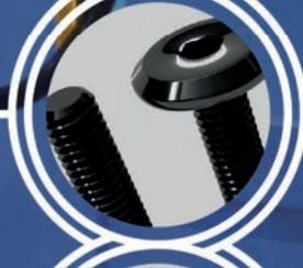
La aleación de Cinc y Níquel utilizada para este recubrimiento electrolítico otorga una elevada resistencia a la corrosión. Pasivado para darle su característico color negro. Si posteriormente se le aplica Top Coat se pueden conseguir distintos acabados mate/brillo
